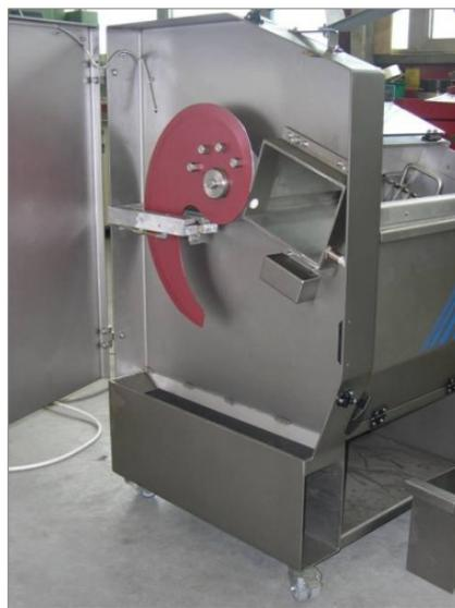
Der Bediener einer Brotschneidemaschine muss vor der Entnahme eines fertig geschnittenen Brotes die Entnahmeklappe öffnen und nach der Entnahme wieder schließen, um das nächste Brot schneiden zu können. Um das zwangsweise Schließen der Entnahmeklappe nach jedem Zyklus zu umgehen, wurde der zugehörige Schalter an der Schutzeinrichtung unwirksam gemacht.
